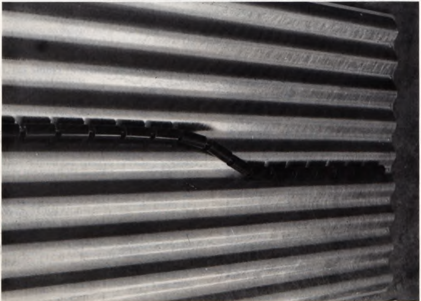
FIGUUR 3. 'n Laboratoriummodel vir skroefontwigtings. Die kettingrollers, geryg in 'n klaviersnaar, verteenwoordig die kristaldeel B. As die rollers oor die golwinge van die sinkplaat rol, beweeg hulle in 'n periodiese gravitasieveld wat die veld van die starre substraat A simuleer. Die oorgang van die ry van een golwing na die volgende simuleer 'n skroefontwigting in 'n adatoommonolaag.
